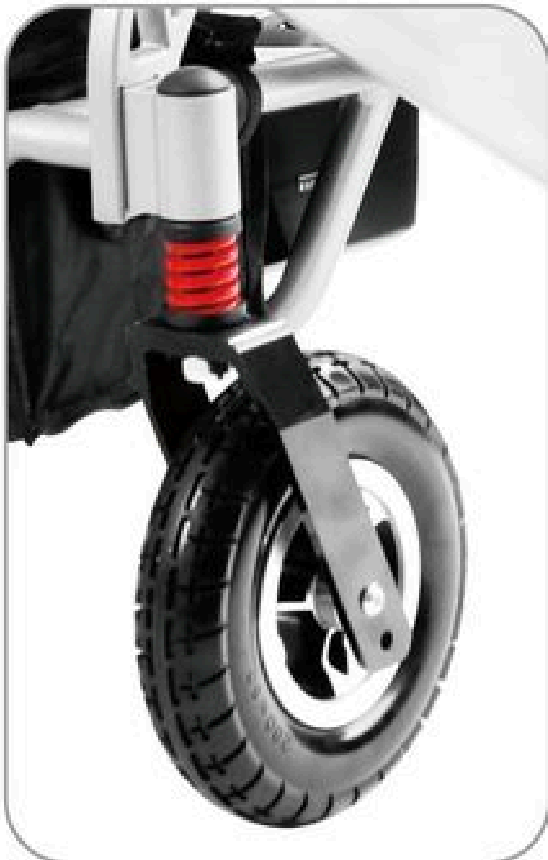
航空级减震前轮叉 Aviation-grade shock-absorbing front fork
